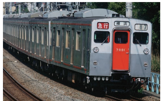
新6000系の性能を基にアルミ車体化した7000系電車 (1975年～)
