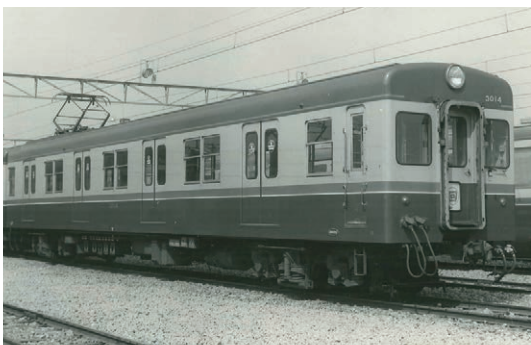
3000系を6000系に合わせて更新した3010系電車 (1964～1999年)
